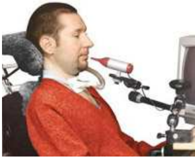
Abbildung 1-4: Maussteuerung mit dem Mund 7
