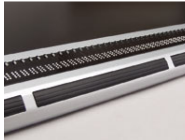
Abbildung 1.3: Ausschnitt der Braillezeile „VarioPro“, in dem die beweglichen Stifte für die einzelnen Zeichen (acht pro Zeichen) erkennbar sind, mit freundlicher Genehmigung der Firma BAUM Retec AG, www.baum.de
