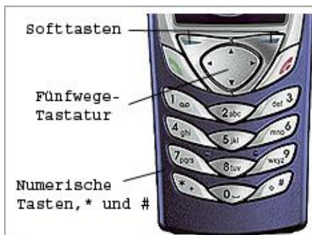
Abb. 3.1: Von Flash Lite 1.x unterstützte Tasten
